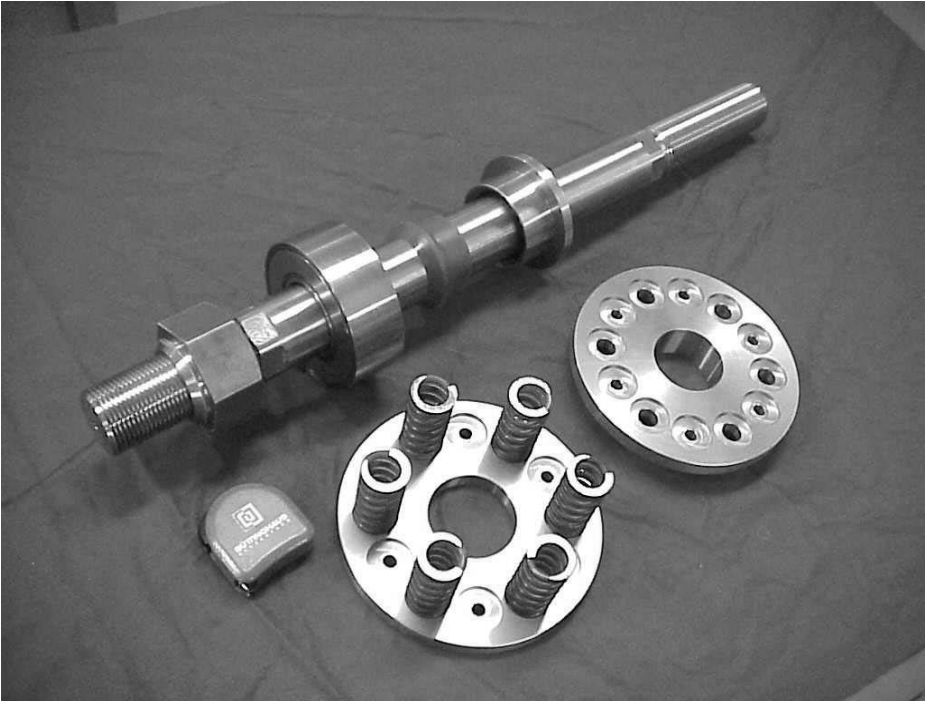
Abbildung 7: Bauteile einer Stangendichtung nach dem Leningrader Prinzip für eine 50 mm Kolbenstange, JOANNEUM RESEARCH 1999.
