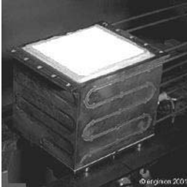
Abb. 7: Porenbrenner für den Dampfmotor /IAV 2000/, /ENGINON 2001/
