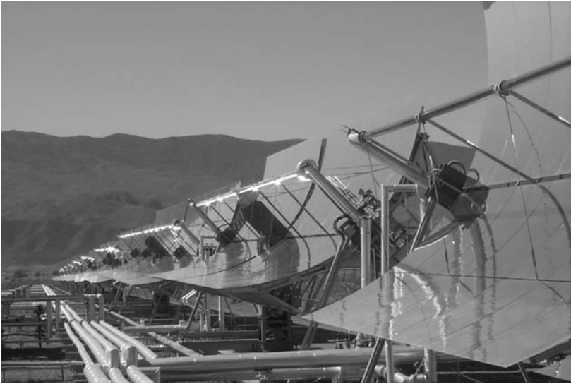
Abbildung 3: 500 m Direktverdampfungs-Testkollektor auf der Plataforma Solar in Almería
