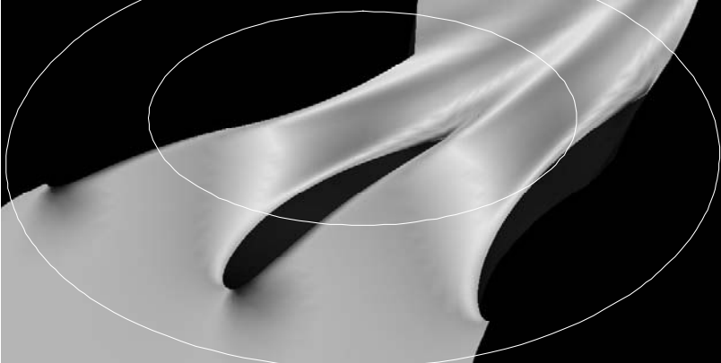
Bild 2: Strömung im Leitschaufelgitter mit Profelnachlauf
